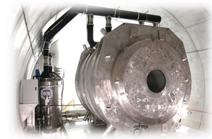
Aimant ISEULT (11,7T) dans le Hall d'étude Neurospin à Saclay
