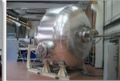
Caisson de test de vide, de dégazage, détection de fuite...
