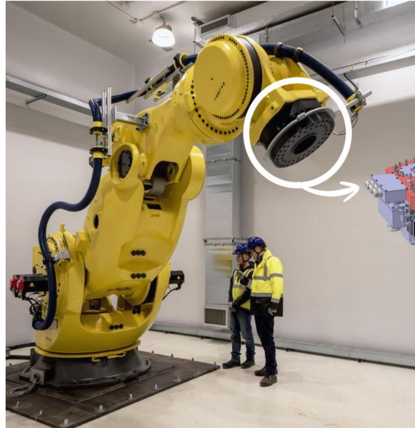
Outillages (Triple Unit Tool Changer – Robot « Godzilla »)
