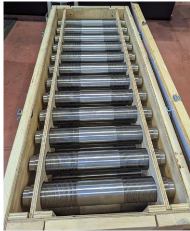
Usinages spécifiques (Flanges) (M80 Bolts)
