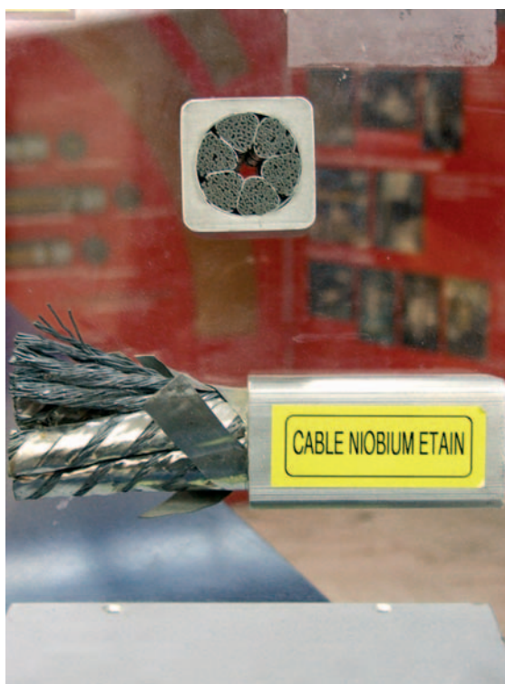
Système de câble développé pour les bobines du solénoïde central d'ITER : six pétales, composés de brins torsadés, sont câblés autour d'une hélice métallique centrale d'environ 10 mm de diamètre interne et 1 mm d'épaisseur. Dans ce concept développé par les équipes du CEA, l'hélium peut circuler à la fois dans la zone centrale et dans la zone des brins.
