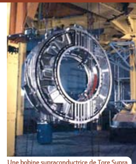
Une bobine supraconductrice de Tore Supra
